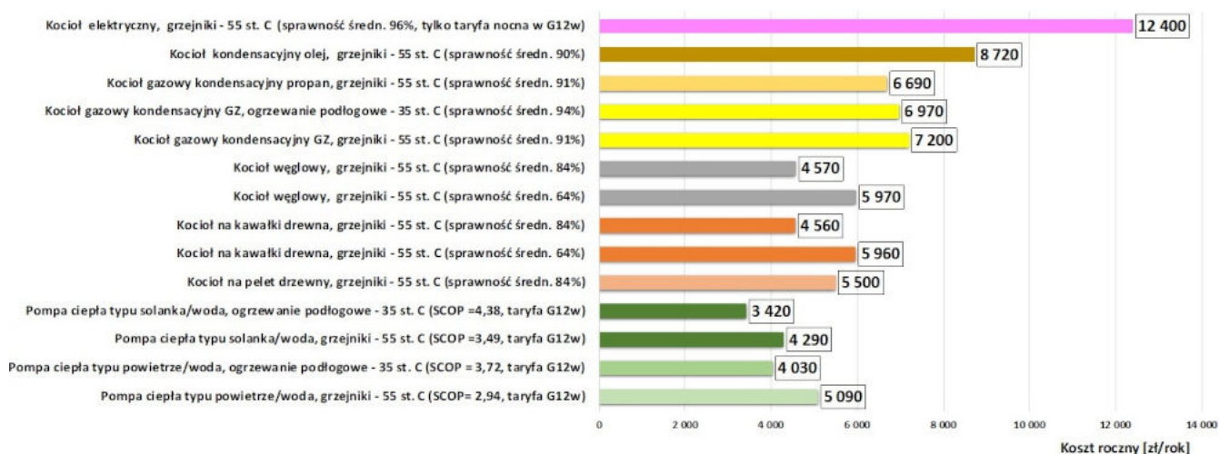
Roczny koszt ogrzewania budynku o pow. 150 m2 (w standardzie WT 2017 i EU=80 kWh/m2rok) oraz przygotowania ciepłej wody użytkowej (liczba osób: 4)
