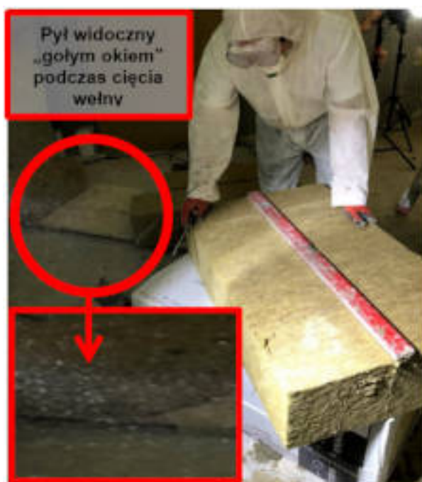
Fot. PSPS: Porównanie emisyjności pyłu podczas docinania (zdjęcia – widoczny pył okiem nieuzbrojonym podczas docinania, po lewej stronie z wełny, po prawej ze styropianu)
