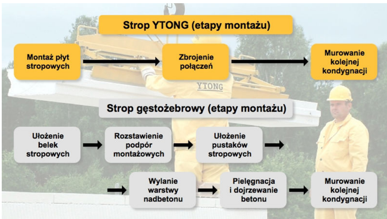
Poszczególne etapy montażu stropów
